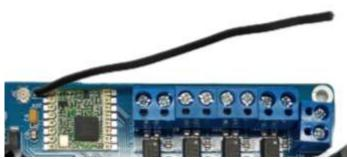
Para placas vendidas com o módulo LoRa, nessa região estará soldado um módulo LoRa RFM95, com frequência de 915MHz.
